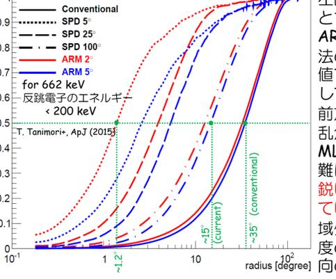
左図は、画像処理を施さない場合、ガンマ線源を中心とする円内に何割の事象が含まれるかを、様々なARM/SPDに対して示したものである。従来コンプトン法の円環を重ねる方式では、コンプトン散乱角の平均値で決定される為、ARMを改善したところでPSFに対しては大きな効果がないことが分かる。COMPTELは、前方散乱が卓越する高エネルギーに特化し、さらに散乱角に制限を与えることで影響を抑えている。従ってML-EM法などの画像処理が必須となり、天体解析を困難にする。一方、ETCCでは、画像処理を行わなくても鋭いPSFが実現でき、その広がりにはSPDに大きく依存している。即ち、SPDの改善によるPSFの向上で、観測領域外からのもれ込みが減るため、雑音量が低減し高感度の観測が可能となる。このことから、電子の反跳方向の効果は非常に大きい。
