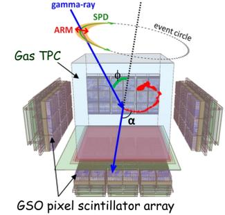
電子飛跡検出型コンプトンカメラ (ETCC)
